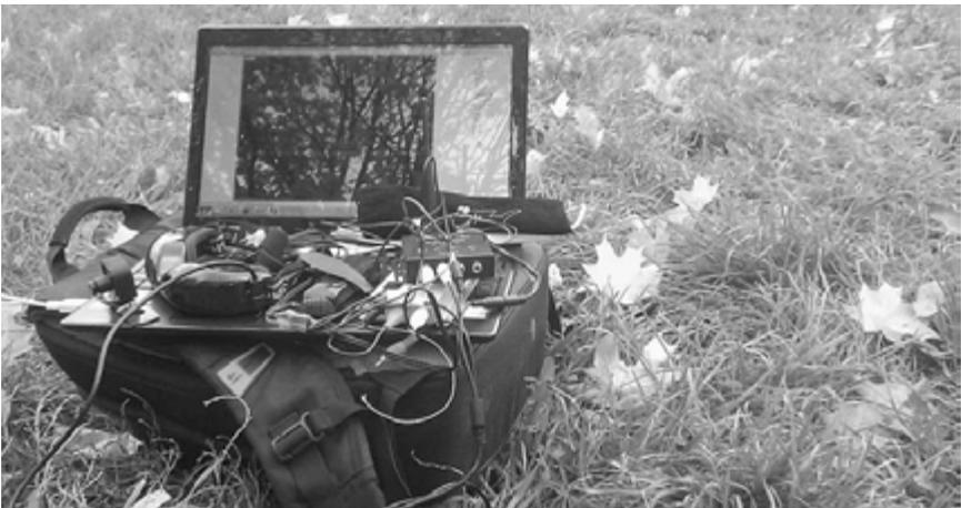
**Фотография оборудования перед полётом в процессе настройки. Ноутбук ACER ASPIRE 5742G, ТВ-Тюнер Iconbit, видеоочки Fatshark (base edition), видеопередатчик (частота 1,2 мегагерца), сплитер, аккумуляторы Lipro3S**
